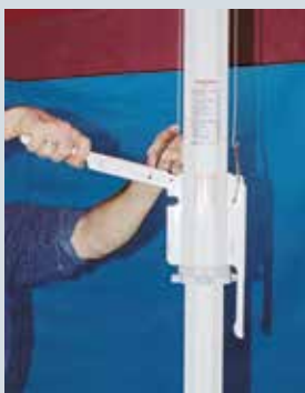
2. Mise sous tension à gauche : Enclencher la bride de ressort jusqu'au déclic, puis abaisser la poignée de serrage. EVENT est alors ouvert.
